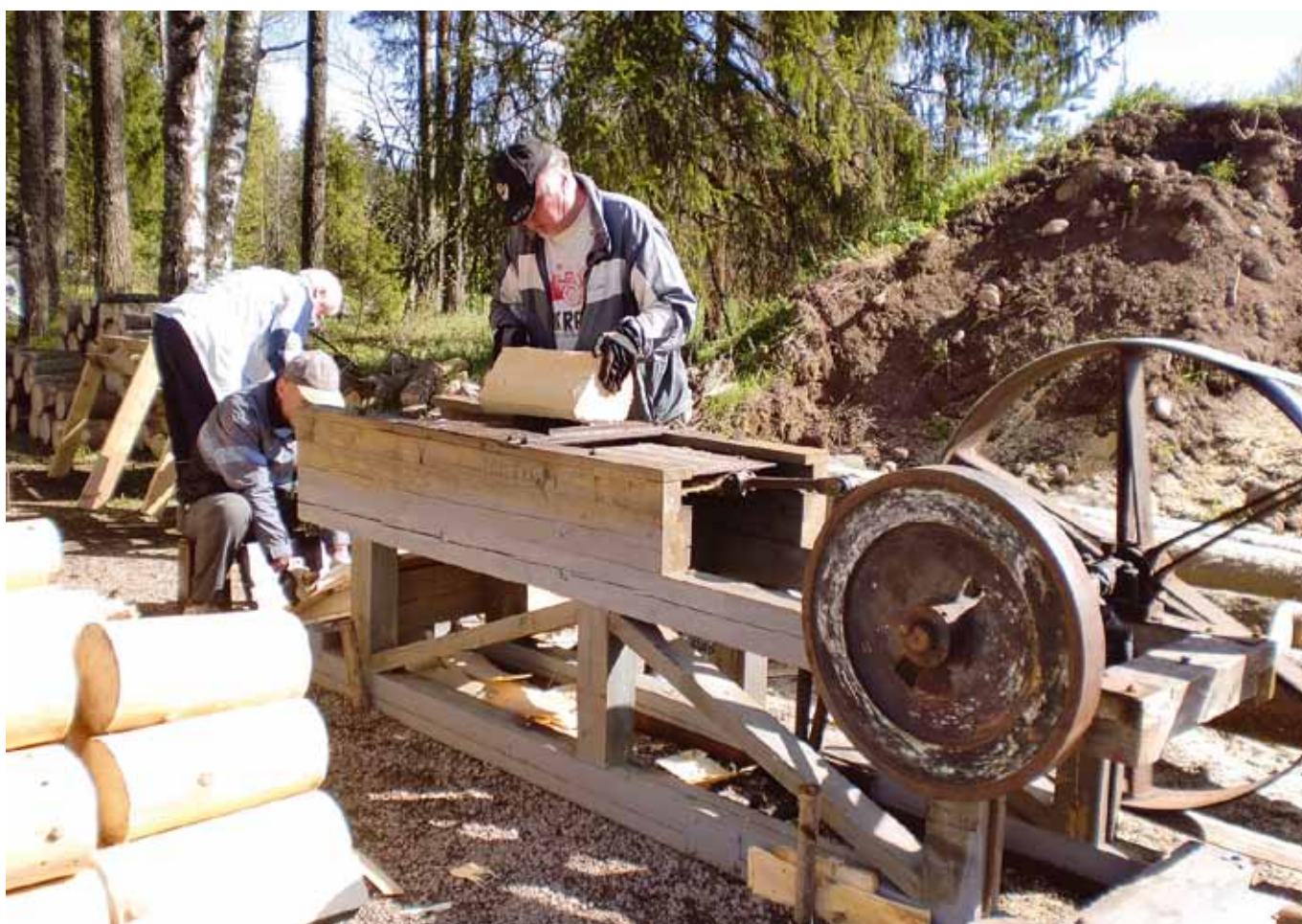
Traktori käytti pärehöylää, jossa pöleistä leikattiin päreet ”siivuina”. Sitä ennen puu oli valikoitu, pätkitty ja kuorittu. Höylääjinä Seppo Runsten Rajamäeltä ja Jaakko Oksanen Röykästä.
